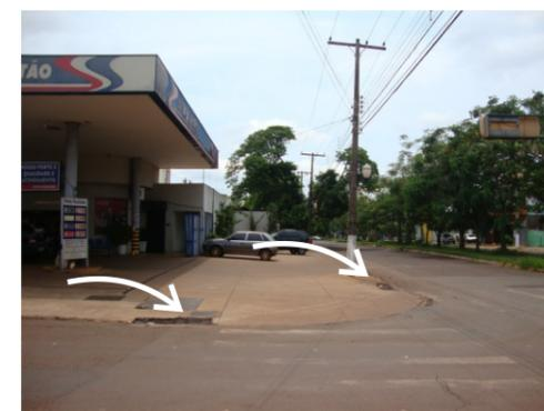
Rebaixo de meio fio em ambas as testadas deixam o pedestre desprotegido, além da grelha pluvial interna ao meio fio que oferece risco.
