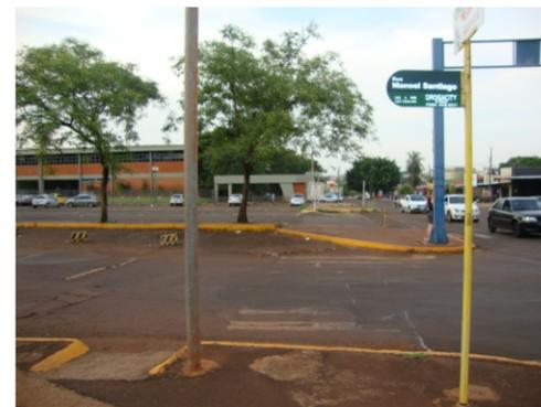
Falta de manutenção da pintura da faixa de segurança e descontinuidade das rampas de PNE.
