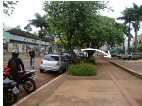
Piso podotátil colocado de forma correta, a segregação entre a calçada e estacionamento protege o pedestre.
