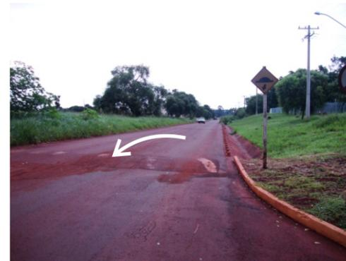
Falta de manutenção na pintura da lombada e área de passeio para pedestres.
