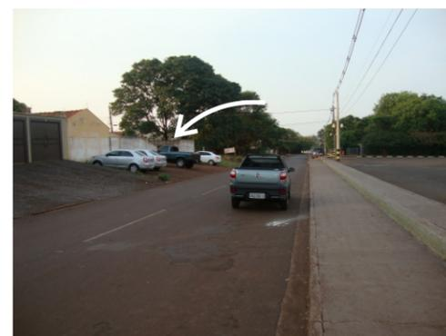
Inclinações elevadas em calçadas e falta de rebaixo de meio fio apenas favorecem o estacionamento de automóveis, deixando o pedestre desprotegido nas manobras de ré.
