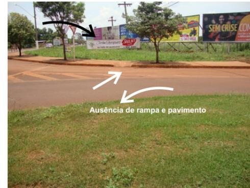
Propaganda implantada em local indevido impede o deslocamento do cadeirante.
