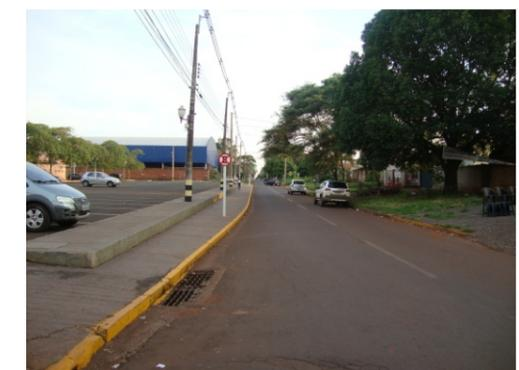
Lado esquerdo da via com falta piso podotátil, rampas PNE e degrau.
