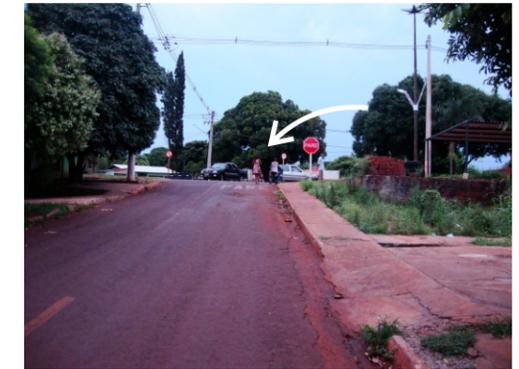
Inclinação da via aliada a falta de manutenção da pavimentação, obriga o pedestre a se deslocar pelo leito carroçável.
