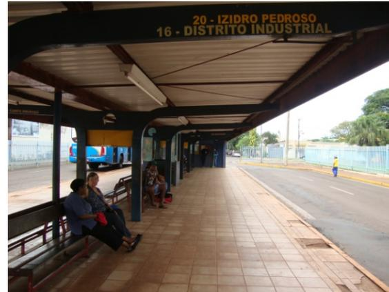
Utilização de piso liso, sem manutenção e ausência de piso tátil.
