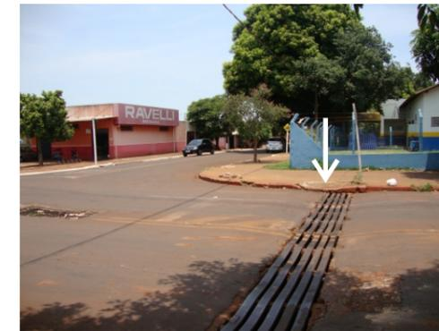
Rampa de cadeirantes em desconformidade com a norma, e a grelha pluvial oferecendo riscos para a roda da cadeira.
