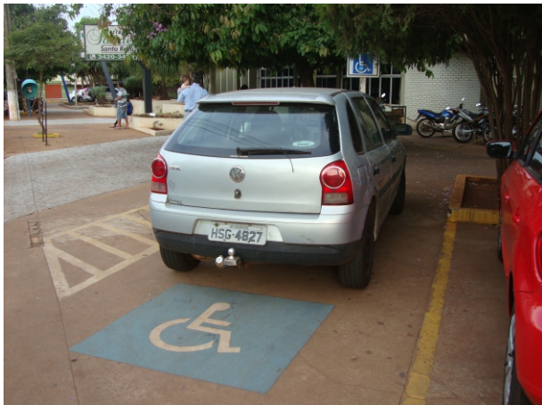
Exemplo em Unidade de Saúde, com sinalização, sem obstáculo e com vaga especial em atendimento a NBR 9050.
