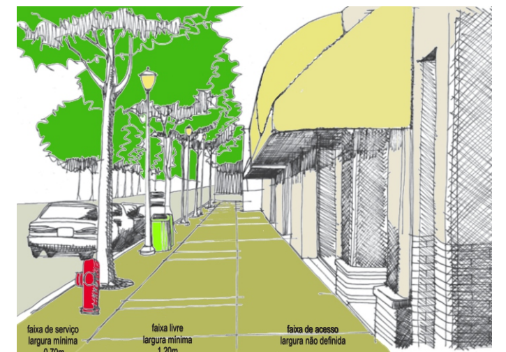
Calçada com largura superior a 2,00m.
